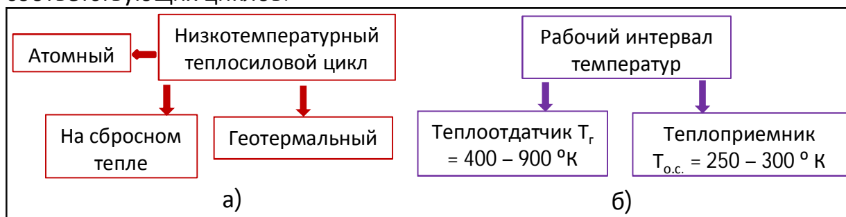
Рисунок 1 – Схема вариантов использования низких температур окружающей среды T_{o.c.} в теплосиловом цикле.
